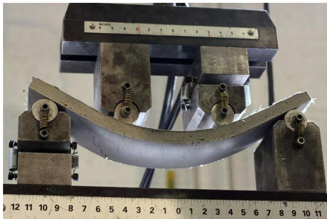
Рисунок 3 – Гибкий бетон
