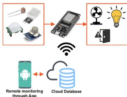
Рисунок 1 – Архитектура системы автоматизации
