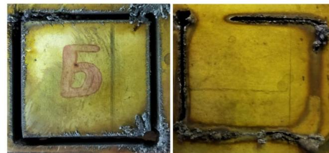
Рисунок 3 – Результат резки образца Б при рекомендованных параметрах к станку
