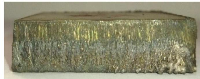
Рисунок 5 – Результат резки образца №2 при измененных параметрах
